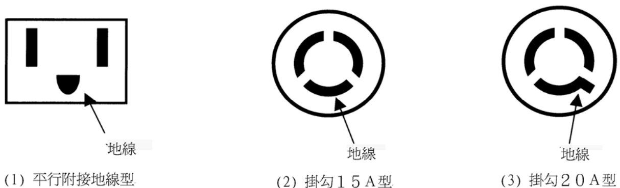
圖 1 附接地線之插座例圖
