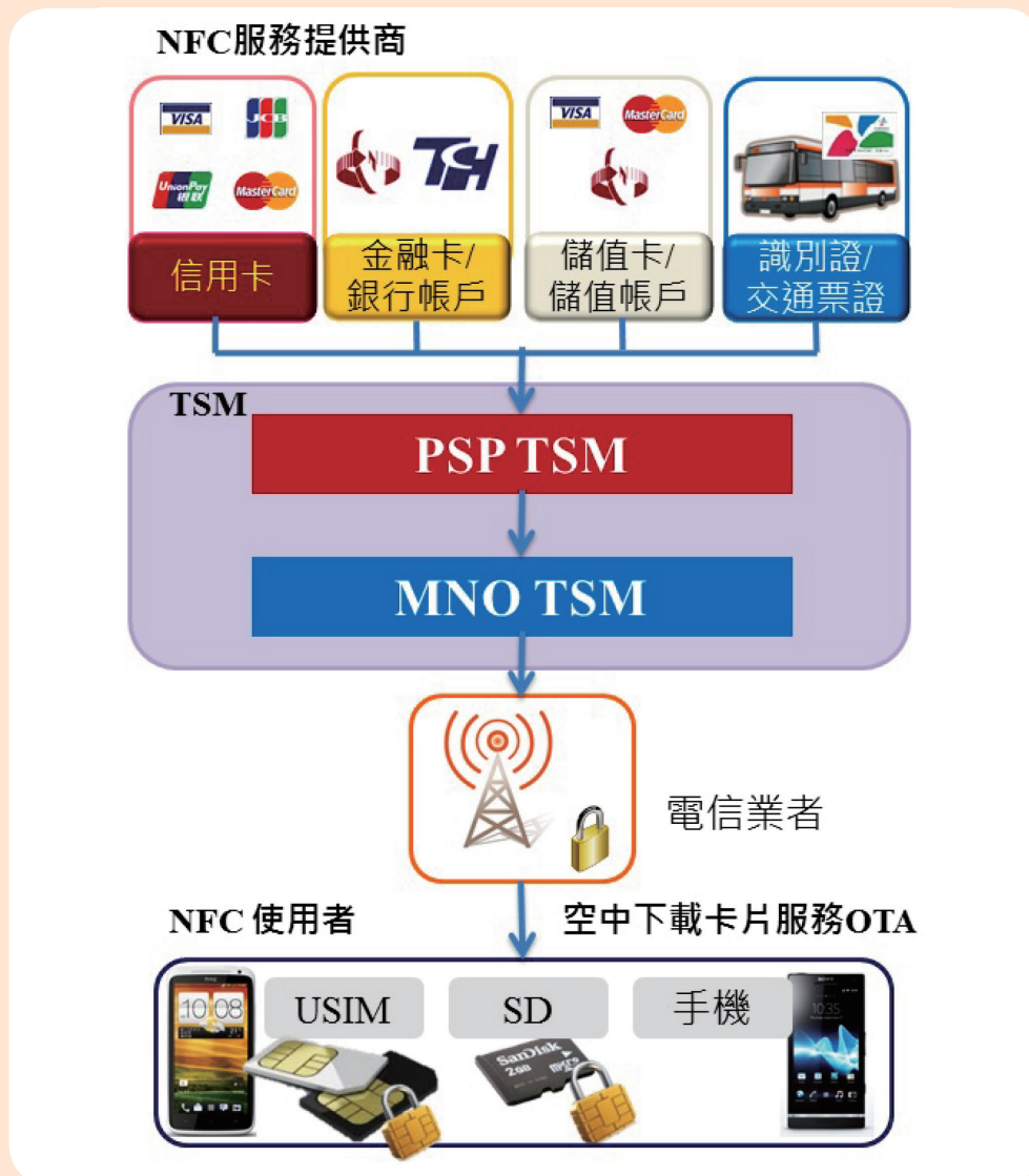
圖三 NFC TSM架構圖
